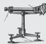
Der Heliotrop steht auf der angepeilten Stelle und reflektiert Sonnenlicht in Richtung der Messanordnung, z. B. zu einem Repetitionstheodoliten. Eine Erfindung von Carl Friedrich Gauss.
